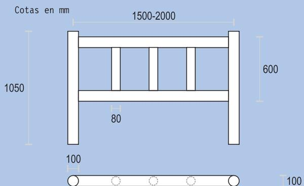
Mecanizados para su acople y fijados con tirafondo.
