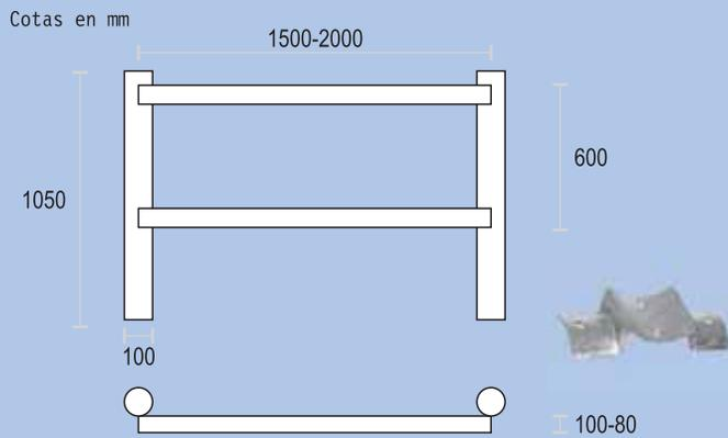
Fijación mediante herraje acero galvanizado.
