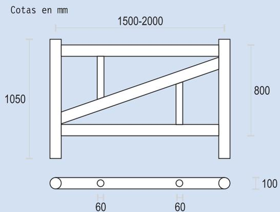
Mecanizado para su acople. Fijado mediante tirafondo.
