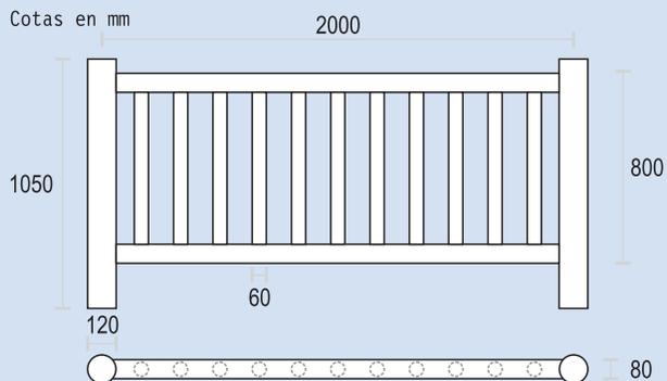
Mecanizados para su acople y fijados con tirafondo. Barrotes verticales empotrados en poste horizontal
