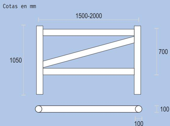
Mecanizado para su acople. Fijado mediante tirafondo.
