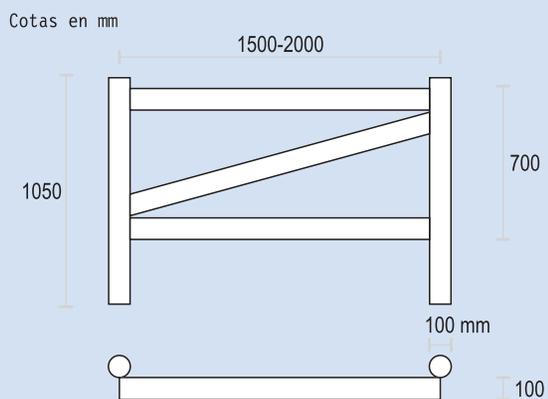
Fijado mediante tornillería pasante.
