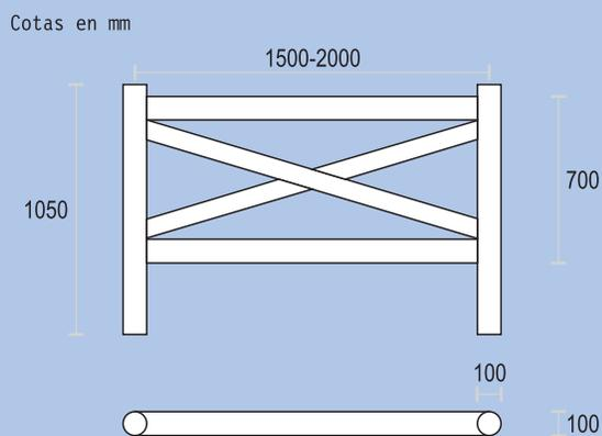
Mecanizado para su acople. Fijado mediante tirafondo.
